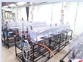
1kL水槽(大型水槽)での飼育実証試験を反復実施 生残率に優れる20Lハーフパイプ型水槽の改良
